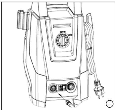
5. Estando com o produto desligado, encaixe a mangueira de alta pressão na saída de água do produto, conforme local indicado na ilustração abaixo. Para a remoção empurre o botão, e ao mesmo tempo, retire a mangueira de alta pressão.
