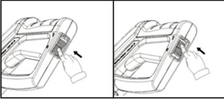
O operador precisa pressionar o botão de desbloqueio e, em seguida, acionar o gatilho para fazer a operação de limpeza. Quando você soltar o gatilho, ele desligará a máquina automaticamente.
