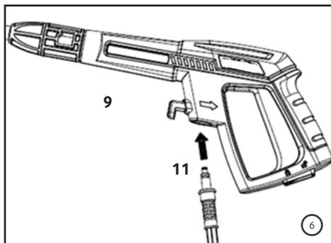
6. Conecte a mangueira de alta pressão (11) à pistola (9). Quando as peças são unidas corretamente, você não conseguirá separar os dois componentes puxando para fora da pistola (11). Para desconectar esses componentes, pressione o botão trava da mangueira e ao mesmo tempo retire a mangueira do bocal de conexão.
