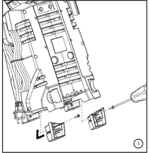
3. Encontre os apoios inferiores direito e esquerdo, e fixe-os com os parafusos fornecidos que poderão ser encontrados juntamente com o Manual de Instruções. Então, com o auxílio de uma chave philips, parafuse-os conforme posição ilustrada na Figura 3.
