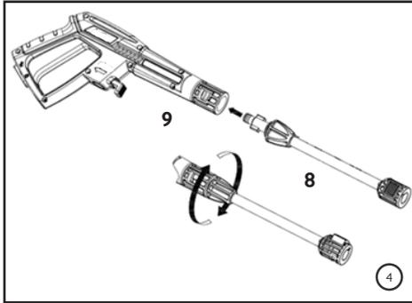
4. A baioneta (8) deverá ser conectada na pistola de alta pressão (9), encaixe-a e gire a no sentido horário até o curso final para travá-la na posição correta. Quando este conjunto for montado, não será possível separar ou desconectar apenas puxando ambas partes, se não ocorrer encaixe novamente até que estes sejam travados. O aplicador de detergente (5) deverá ser conectado na pistola de alta pressão (9) da mesma maneira.
