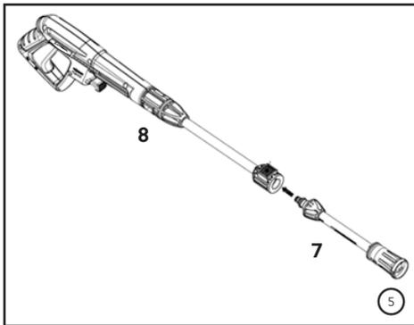
5. Encaixe a lança com bico regulável (7) na baioneta (8) seguindo o pino guia e as setas indicando a posição correta de travamento. Após realizado a montagem, você não irá
