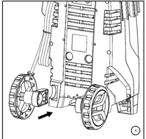
4. Em seguida, deve-se conectar o conjunto roda no sentido e posição indicada na Figura 4, este será conectado após identificar um barulho de "click". Posteriormente, puxe a roda para garantir que ela está fixada corretamente.
