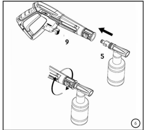
6. Para utilizar detergente, insira o aplicador (5) na pistola de alta pressão (9), em seguida pressione e gire no sentido horário até atingir a posição correta conforme ilustrado na Figura 7. Quando este conjunto for montado, não será possível separar ou desconectar apenas puxando ambas partes, se ocorrer encaixe novamente até que estes sejam travados. Para desconectá-las repita o processo inverso.
