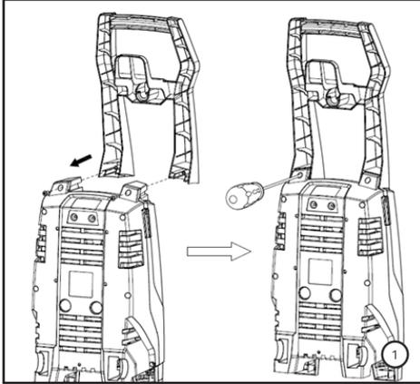
1. Retire os parafusos embalados juntamente com Manual de Instruções, e com o auxílio de uma Chave Philips parafuse-os para fixar a alça (2) no produto.
