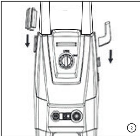
2. Os suportes dos acessórios estão embalados juntamente com o Manual de Instruções, retire-os da embalagem e fixe conforme posição e sentidos de encaixe ilustrados abaixo.
